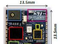
SensorTile (STEVAL-STLCS01V1)は、各種センサ、マイク、Bluetooth low energy、そしてマイコンが実装された小型ボード(13.5mm²)です。本体のみのスタンドアロンやクレードルとの組み合わせで、各種デモ用のサンプルプログラムを動かすことができますが、今後の展開に備えて STM32 Nucleo に接続できる構造になっています。
