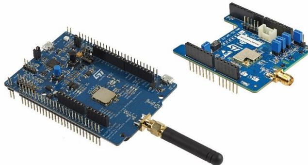
LoRaWAN<sup>™</sup>対応システムの評価・開発を、低コストで始められる STM32 LoRa<sup>®</sup> Discovery kit 「B-L072Z-LRWAN1」(写真左)と、STM32 Nucleo ボード用拡張ボード「I-NUCLEO-LRWAN1」(写真右)の2種類の開発ボードをリリースしました。
