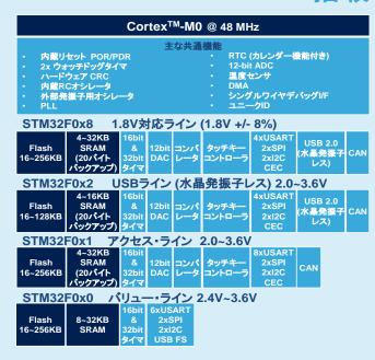
STM32F0 シリーズは、コスト重視のアプリケーションに最適な、エントリレベルの 32bit マイコンです。幅広い Flash メモリ・サイズ (16KB~256KB) と豊富なパッケージ (20~100 ピン:TSSOP、LQFP、BGA、WLCSP)、およびニーズに合わせて選択できる 4 つの製品ライン (バリュー・ライン / アクセス・ライン / USBライン / 低電圧ライン)を揃えており、多様なアプリケーションに対応します。
