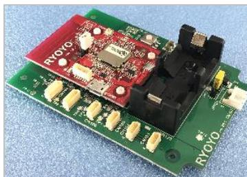
昨今、IoT を使ったシステム導入が活発化していく中、PoC 途中での要件や要求仕様の変化に対する柔軟性を求める声が高まってきています。この声に対応するため、菱洋エレクトロ社は豊富なセンサ類を標準サポートし、LoRaWAN / Wi-Fi に対応した PoC 用ノード・モジュールを開発しました。これにより IoT システム導入に向けた PoC をスムーズに実施できる柔軟な環境を提供します。
