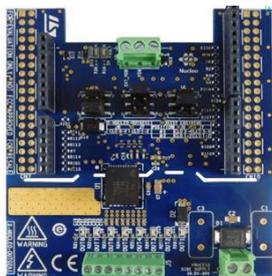
ハイサイド・パワースイッチ「ISO8200AQ」を搭載する X-NUCLEO-OUT02A1 は、STM32 Nucleo ボード上のマイコンで評価することができます。また、NUCLEO-F401RE、NUCLEO-F334R8 であれば、ST から提供するサンプルソフトですぐに評価が可能です。
