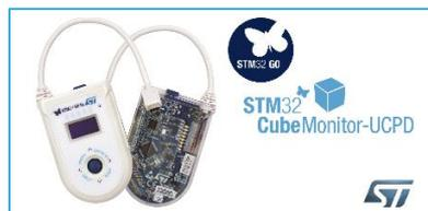
STM32G0 シリーズ向けに、認証済み USB Type-C / Power Delivery 3.0 プロトコルをすぐに評価できるツールをリリースしました。STM32G0 シリーズは、最大 2 ポートの USB PD インタフェースが搭載されており、それぞれ USB Type-C の SNK (シンク : 受電側)、SRC (ソース : 給電側)、DRP (Dual Role Power) に対応しています。また PPS (Programmable Power Supply)、CC 通信信号を介したファームウェア・アップグレード、認証メッセージなどのオプションの USB PD 機能もサポートしています。STM32CubeMX もアップグレードされており、ポート数を設定して SNK、SRC または DRP を選択できる新機能が追加されています。
