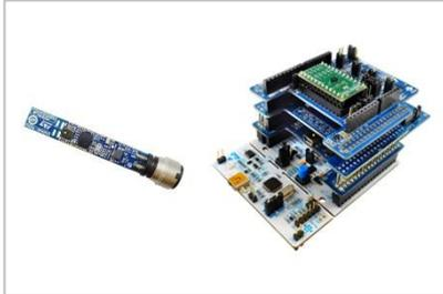
FP-IND-PREDMNT1 は、各種センサのデータ取得はもちろん、加速度センサの FFT 処理が可能のため、振動を周波数ドメインで観測、産業システムの予知保全機能に最適です。Bluetooth® Low Energy にも対応し、スマートフォン・アプリによる FFT パラメータ設定およびデータの観測が可能です。
