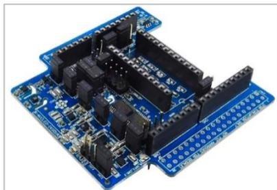
X-NUCLEO-IKS01A3 は、各種モーション・センサと環境センサを搭載した STM32 Nucleo 用の MEMS センサ用拡張ボードの最新版です。制御用の STM32 Nucleo には、NUCLEO-F401RE / -L053R8 / -L073RZ / -L152RE / L476RG が最適です。
