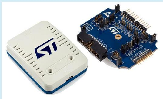
STLINK-V3 は、USB マスストレージ・クラス、各種ペリフェラルに対応した仮想 COM ポートとマルチパス・ブリッジを備えているほか、書込み速度は従来より 3 倍高速化されており、開発現場で簡単に機器を再プログラミングできます。標準的な JTAG / シリアル・ワイヤ・デバッグ (SWD) およびシングル・ワイヤ・インタフェース・モジュール (SWIM) 通信に加え、仮想 COM ポート (VCP) とマルチパス・ブリッジにより、マイコンの各種インタフェース (UART、I2C、SPI、CAN) や GPIO による通信が可能です。
