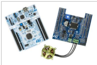
STM32 Nucleo Pack「P-NUCLEO-IHM001」は、Cortex-M4 マイコンである STM32F302 を搭載した STM32 Nucleo 開発ボードと、モータドライバ L6230 を搭載した機能拡張ボード X-NUCLEO-IHM07M1 を同梱した、3 相ブラシレス DC モータを評価するための開発キットです。さらに、モータドライバへの電源供給を行う AC アダプタを同梱したものが「P-NUCLEO-IHM002」です。
