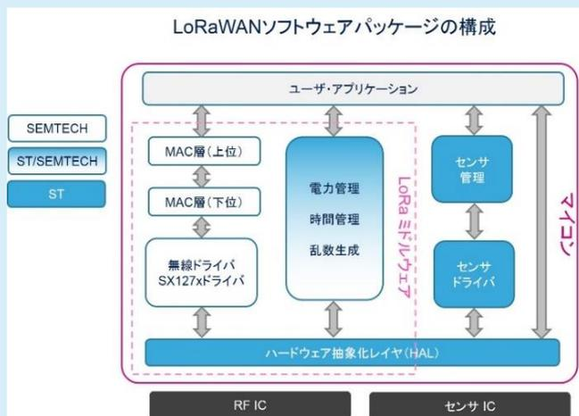
開発ボード「B-L072Z-LRWAN1」とソフトウェア・パッケージ「I-CUBE-LRWAN」は、長距離無線規格である LoRaWAN 対応機器の開発ツールです。
