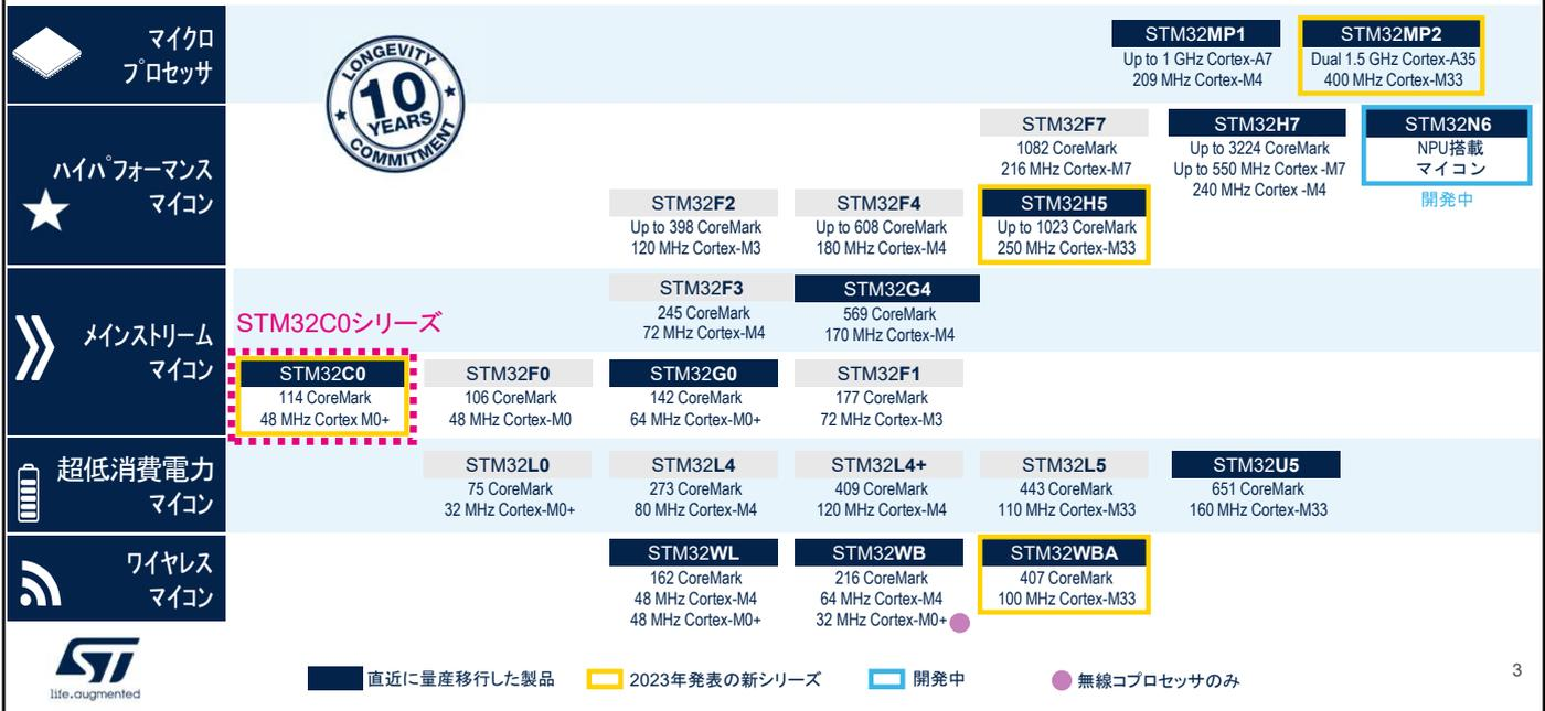
このスライドでは、STマイクロエレクトロニクスによって設計されたMCUおよびMPUのポートフォリオを要約しています。MPU、ハイパフォーマンスMCU、メインストリームMCU、超低消費電力MCU、ワイヤレスMCUの5つのカテゴリに分類されます。STM32C0は、メインストリームMCU製品ラインに属します。これは、最大48MHzで動作できるエントリーレベルのマイクロコントローラです。CoreMarkで表現される性能は114で、STM32F0シリーズの性能をわずかに上回ります。
