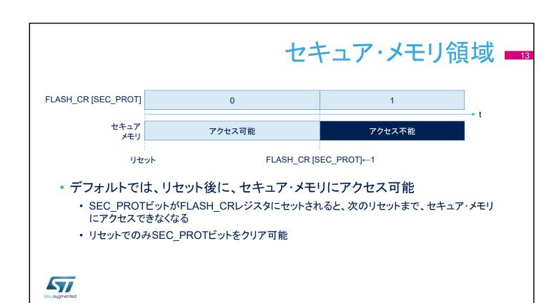
ソフトウェアで FLASH\_CR レジスタに SEC\_PROT ビットをセットすると、セキュアメモリはアクセスできなくなります。 Flash メモリイメージの認証および復号化の実行に使用されるセキュアブートの場合、SEC\_PROT ビットは、認証に成功したときに、イメージの最初の命令に分岐する直前に 1 にセットされます。
