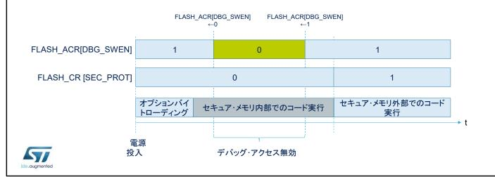
侵入型デバッグを使用した Cortex-M0+ の制御は、 DBG\_SWEN 制御ビットを適切にプログラミングすることにより、 一時的に無効にすることができます。
