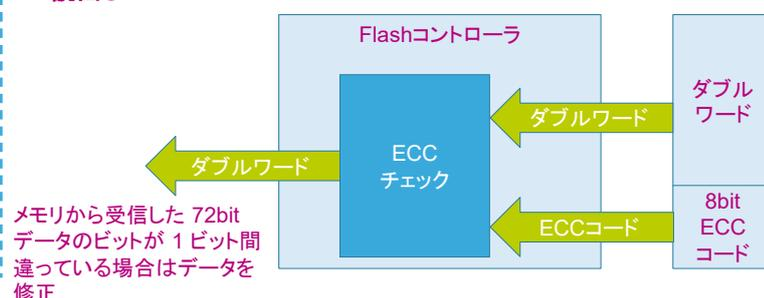
フラッシュメモリワードデータは72ビット幅で、各ダブルワード(64ビット)ごとに8ビットが追加されます。ECCメカニズムは以下をサポートします
