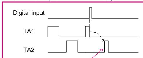
PWMシャットダウン前に代替でHWによってコピーされた短縮パルス
