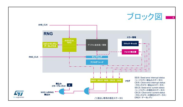
このRNGが単純化されたブロック図には、その基本的な機能モジュールと制御モジュールが示されています。
