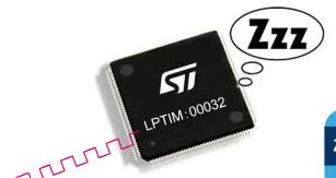
LPTIM は 16ビット・タイマ クロック・ソースの多様性により、LPTIM は STM32H7マイクロコントローラで利用可能な 多くの低電力モードで実行し続けることが可能
