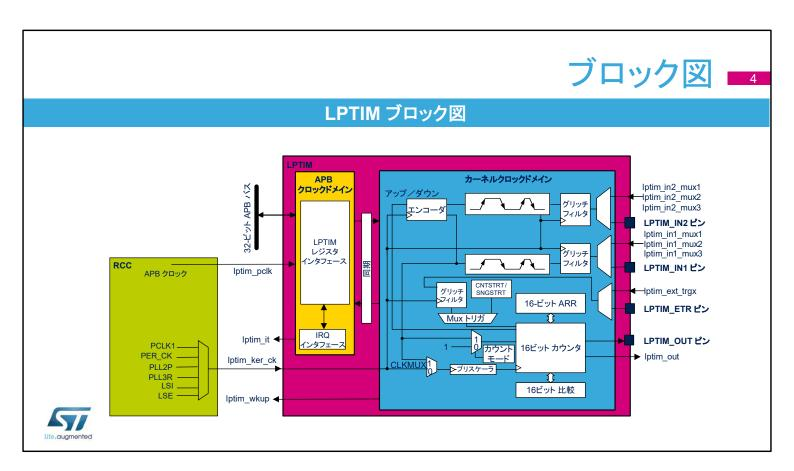
低電力タイマは、2 つのクロックドメインを持つペリフェラルです。 APB クロックドメインには、ペリフェラルの APB インタフェースが 含まれています。カーネルクロックドメインには、低電力タイマペ リフェラルのコア機能が含まれています。カーネルクロックドメイ ンは、タイマの「LPTIM\_IN1」入力経由の外部クロックソースから の内部クロックソースによってクロック供給を受けることができま す。
