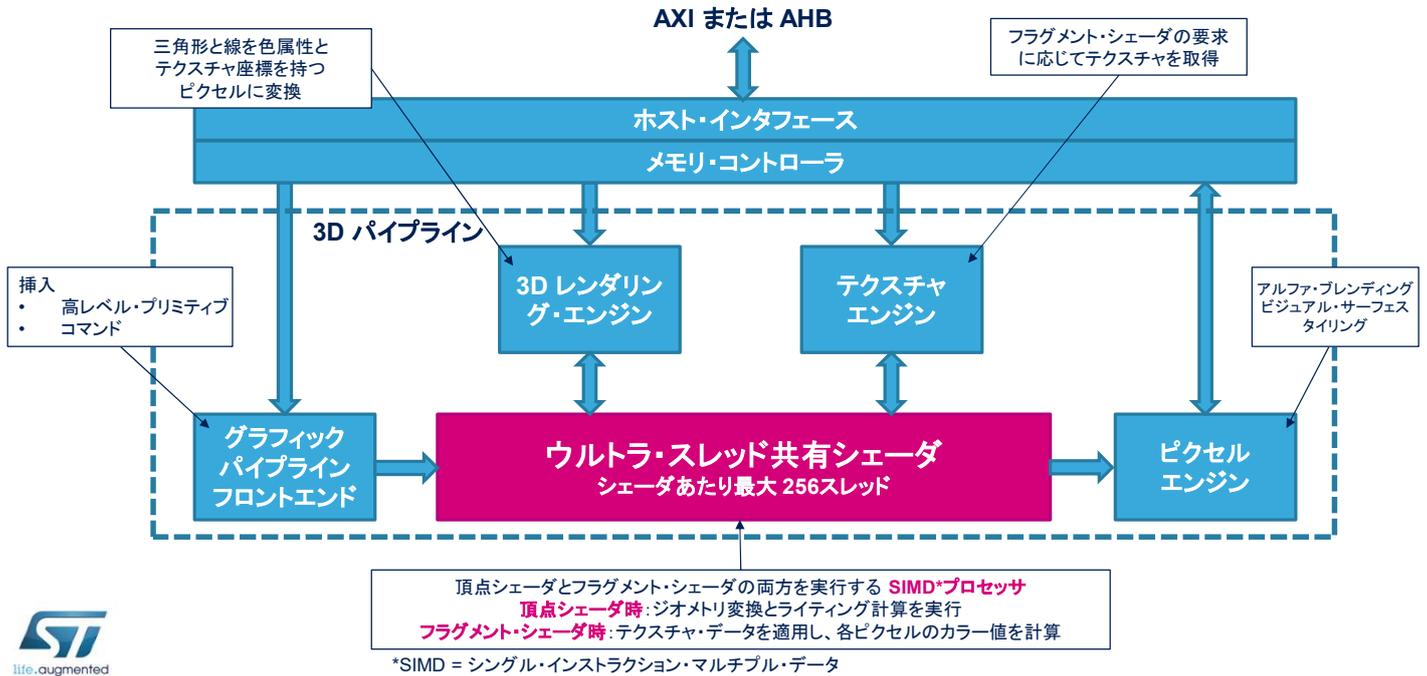
GPU には、クラス最高のグラフィック高速化を実現する以下の主要な専用ブロックがあります。
