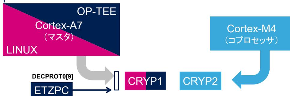
CRYP1 はセキュアペリフェラルです (ETZPC\_DECPR0T0 bit 9 で ETZPC 制御下)。
