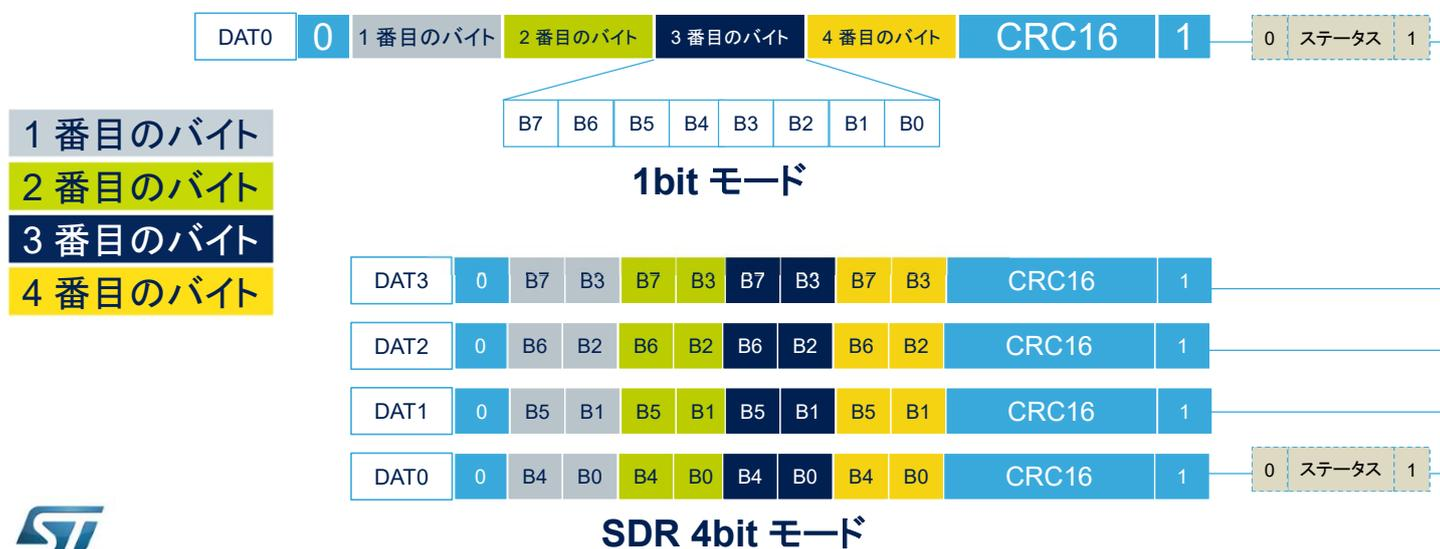
シングルデータレート (SDR) モードでは、データバスは設定したデータバス幅に応じて、1 つ (SDMMC\_D0)、4 つ (SDMMC\_D0~SDMMC\_D3)、または 8 つのピン (SDMMC\_D0~SDMMC\_D7) からデータブロックを送信します。
