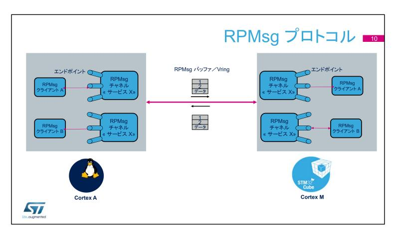
STM32 MPU 組込みソフトウェアディストリビューションでは、RPMsg プロトコルがプロセッサ間通信に使用されます。
