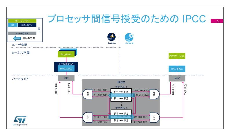
STM32MP1 に統合された IPCC ペリフェラルは、Cortex-A7 と Cortex-M4 間の通信用に 6 つの双方向チャネルを提供します。 原理は、次のとおりです。
