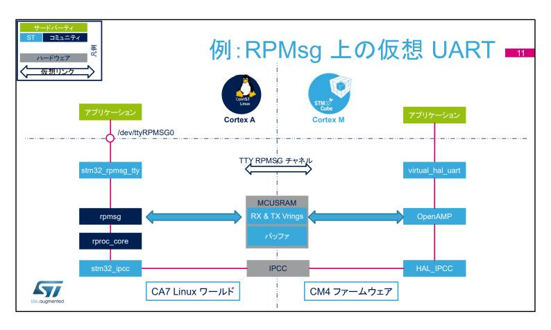
この仮想 UART は、RPMsg プロトコルを使用するアプリケーションを示すために STM32MP1 デバイス用に実装した例です。ここでの目的は、RPMSg プロトコルで UART をシミュレートすることです。
