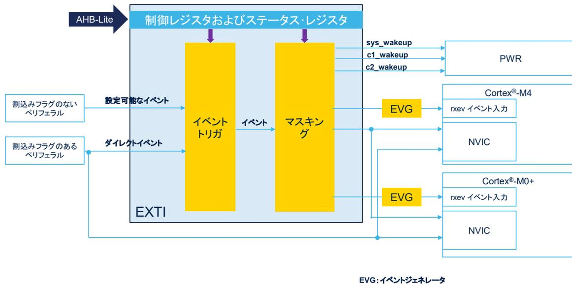
拡張割り込み/イベントコントローラのブロック図を示します。割り込み機能はないけれどもパルスの生成が可能なペリフェラルでは、設定可能なイベントが生成されます。EXTI コントローラは、割り込みの検出、マスキング、およびソフトウェアトリガを提供します。割り込みリクエストに対応したペリフェラルでは、ダイレクトイベントが生成されます。この場合、EXTI コントローラを使用して、CPU に対するイベントが生成され、システムウェイクアップがリクエストされます。拡張割り込みとイベントコントローラは、設定可能なイベント 1 つごとに、両方の CPU に対して割り込みを 1 つずつ発行します。CPU のウェイクアップは個別に発行されるので、両方のプロセッサを別々にウェイクアップできます。
