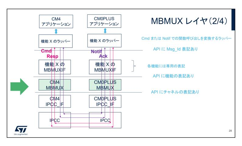
MBMUX の下位レイヤは IPCC の直上に位置し、そのタスクは チャネルへの機能のマッピングです(登録と多重化を提供)。 IPCC\_IF および MBMUX の下位レイヤは汎用サービスです (ユーザによる変更は想定されていません)。
