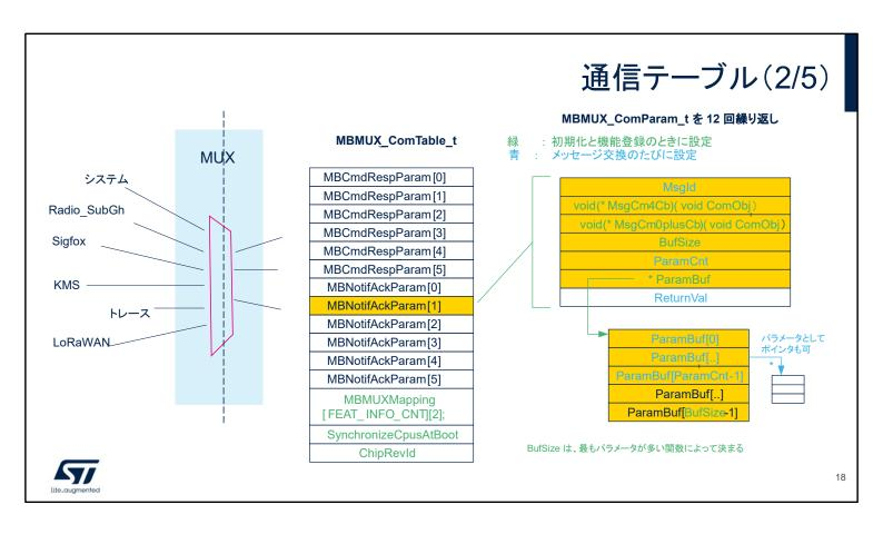
たとえば、トレース機能が登録を求め、それに MBNotifAckParam[1] が割り当てられたとします。トレース機能は Rx チャネルのみを必要とするので MBCmdRespParam インスタンスの登録は不要です。 CM4 に対して CMOPLUS のみがトレース関数を呼び出し、他の呼び出し形態はないからです。 2 つのコア間でのトレース関数の呼び出しごとに MsgID があります。トレースの ParamBuf は、パラメータが多いほうのトレース関数から計算されます。 パラメータが最も多い関数のパラメータ数が 5 であれば、 BufSize パラメータは 5 に設定されます。
