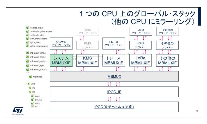
これは、前の図にある 2 つの列の 1 つを詳しく表した図です。 すべての MBMUXIF と相互作用する "システム MBMUXIF" を 除き、各 MBMUXIF ブロックは機能間で独立しています。 MBMUX とシステム MBMUXIF はメールボックスの中核的存在 です。
