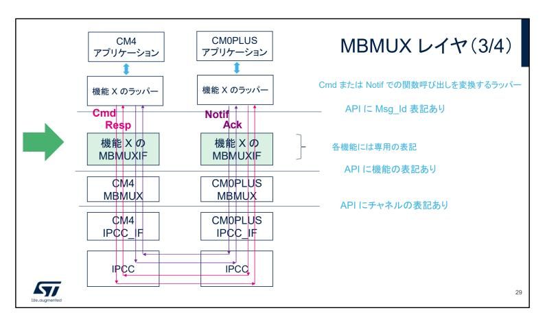
各機能は、それに専用の MBMUXIF によって MBMUX とインタフェース接続します。新しい機能を追加するには、該当の MBMUXIF を実装する必要があります。
