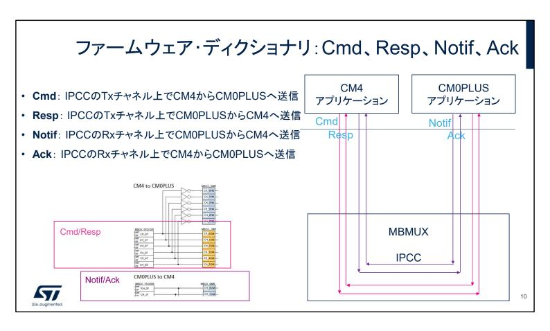
IPCC のチャネルは、Tx と Rx のペアを複数使用して編成されています。MBMUX では、Tx チャネルをコマンド/レスポンス、Rx チャネルを通知/確認応答に使用しています。
