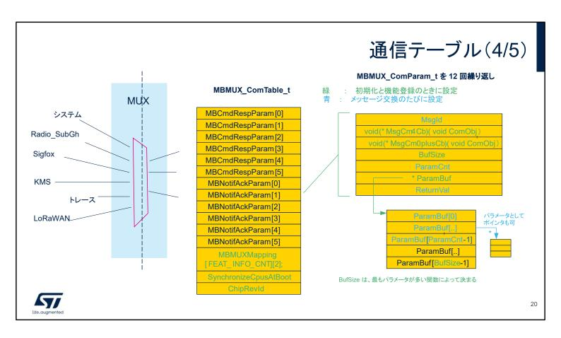
交換するデータまたは 2 つの CPU からアクセスするデータを収めるバッファ(メールボックス・バッファ、パラメータ・バッファ、各パラメータが指すバッファ)は、すべて共有メモリとする必要があります。
