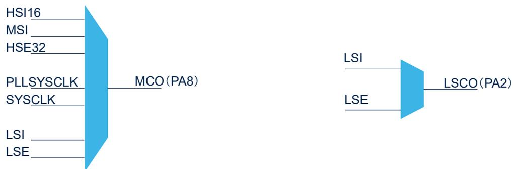
RUN モードと STOP モードでは GPIO ピン PA8 でマルチクロック出力が可能で、さまざまな高速クロックと低速クロックを選択できます。
